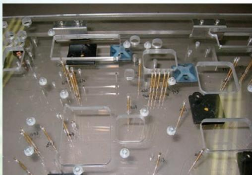
回路基板検査治具 PCB inspection jig
